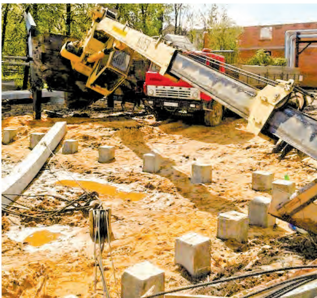
▲Автокран упал из-за отсутствия одной опоры
